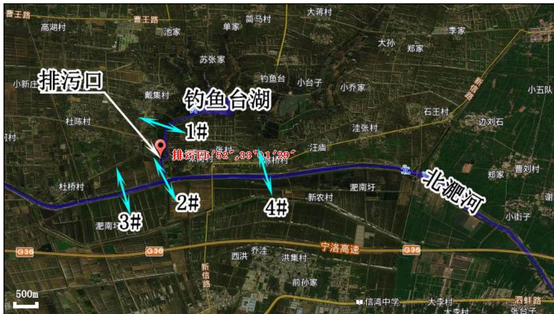
图 3.2-2 地表水监测断面布设图
