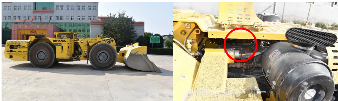
图 13 柴油铲运机侧面图（左）及发动机涡轮增压器图（右）
